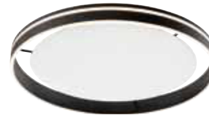
Q-VITO 8416-13 Deckenleuchte/ceiling lamp, LED-Board, 2700-5000K, 1 x 39W, 4000 Lumen incl., dimmbar über Funkfernbedienung inkl./ dimmable with radio remote control incl., Ø 590, T 80
